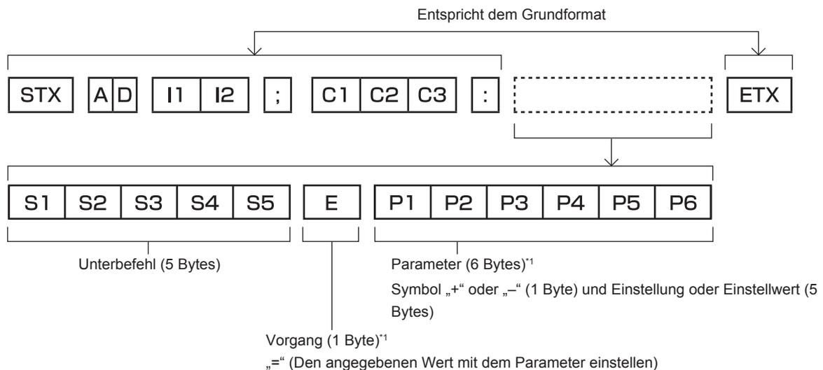
\*1 Bei der Übertragung eines Befehls, der keinen Parameter benötigt, sind Vorgang (E) und Parameter nicht erforderlich.
